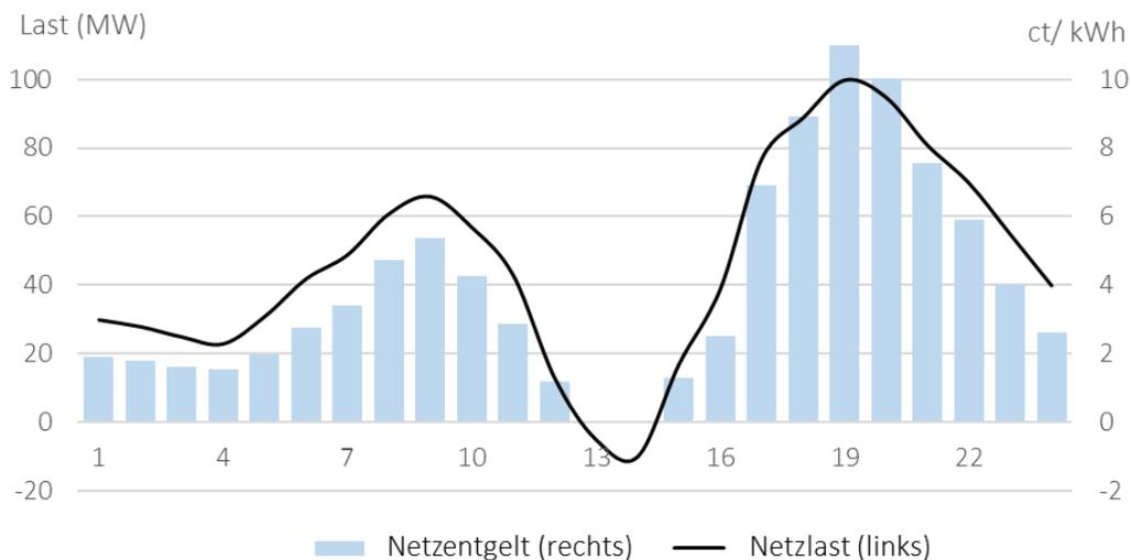
Abbildung 5. Illustration eines dynamisches Netzentgelt, das in Abhängigkeit der gemessenen Netzlast variiert.
